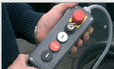
Commande électrique par boîtier sur câble depuis le sol
