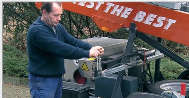
Poste de commande de l'entraînement de manœuvre
