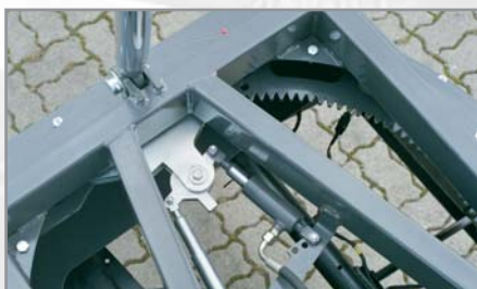
Blocage de couronne pivotante en continu, à déblocage hydraulique
