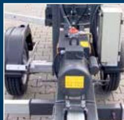
Essieu rétractable, largeur de manœuvre de 0,89 m (en option)
