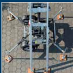
L'emprise au sol de 4,6 m 2 seulement permet l'utilisation aux endroits les plus étroits
